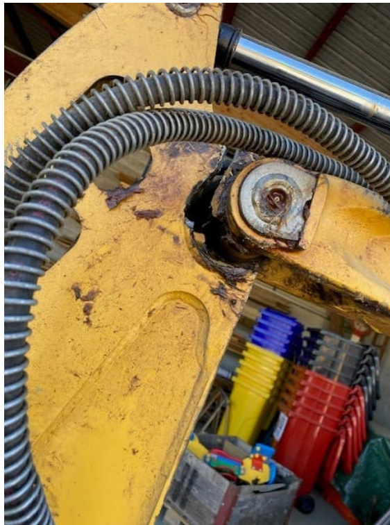
Casse au niveau de l'axe de rotation du bras
