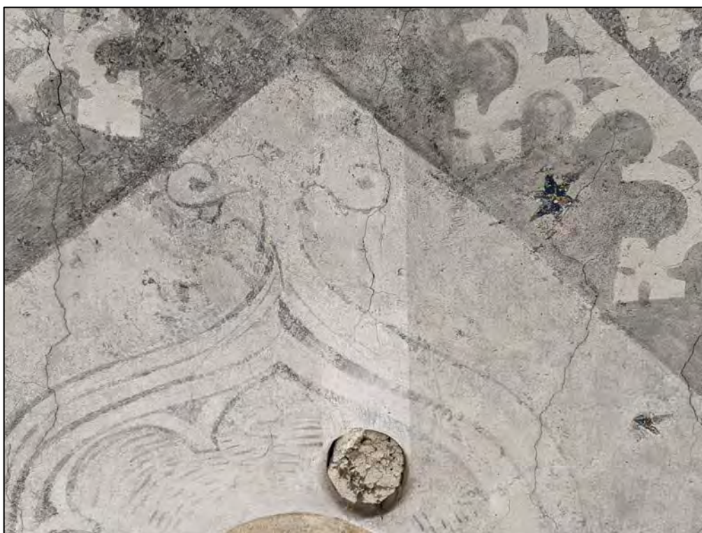
Figure 9 : essai de nettoyage à sec à la Wishab.
